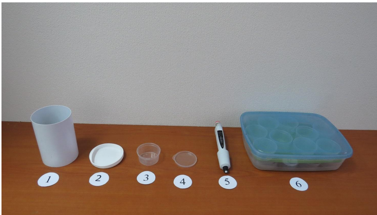
Рисунок 1. Основные составляющие комплекта для измерения дыхания почвы в полевых условиях: 1 – сосуд-изолятор, 2 – крышка к сосуду, 3 – чашечка для раствора щелочи, 4 – крышка к чашечке, 5 – пипетка на 10 мл, 6 – мини-контейнер для хранения и перевозки чашечек. Фото автора.
