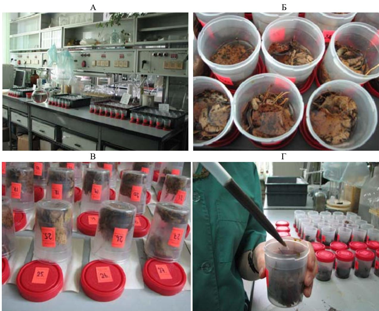
**Рисунок 1.** Постановка лабораторного эксперимента: А – общий вид эксперимента с опадом березы; Б – крупный план емкостей с опадом; В – просушивание опада, после удаления водных или солевых вытяжек; Г – добавление к опадку почвенной водной суспензии.
