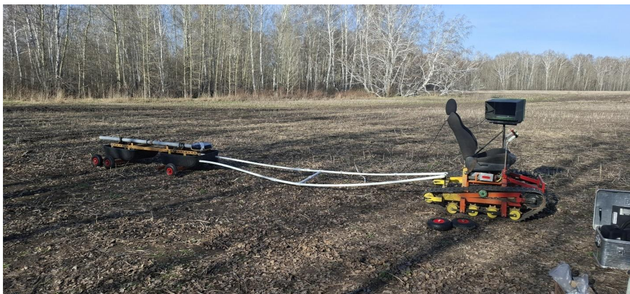
Рисунок 1. Аппаратура ЭМС, буксируемая гусеничным транспортером (Фото Ю. Г. Карина).
