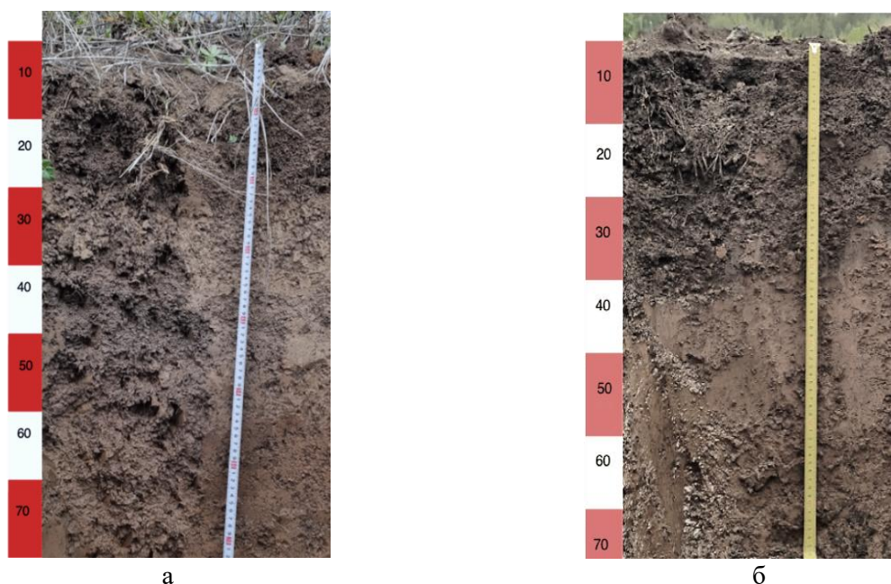
Рисунок 2. Внешний вид темногумусовых фоновой постагрогенной (а) и нефтезагрязненной (б) почв.
