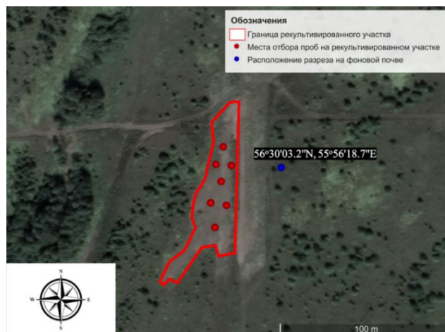
Рисунок 1. Расположение разреза на фоновой темногумусовой почве и схема отбора почвенных проб на нефтезагрязненной почве.
