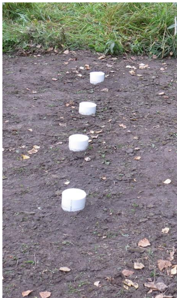
Рисунок 2. Определение дыхания почвы на залежном и парующемся участках. Фото автора.
