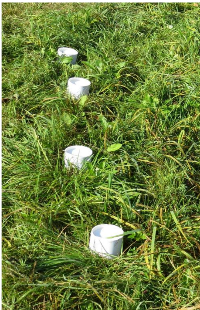
Рисунок 2. Определение дыхания почвы на залежном и парующемся участках. Фото автора.
