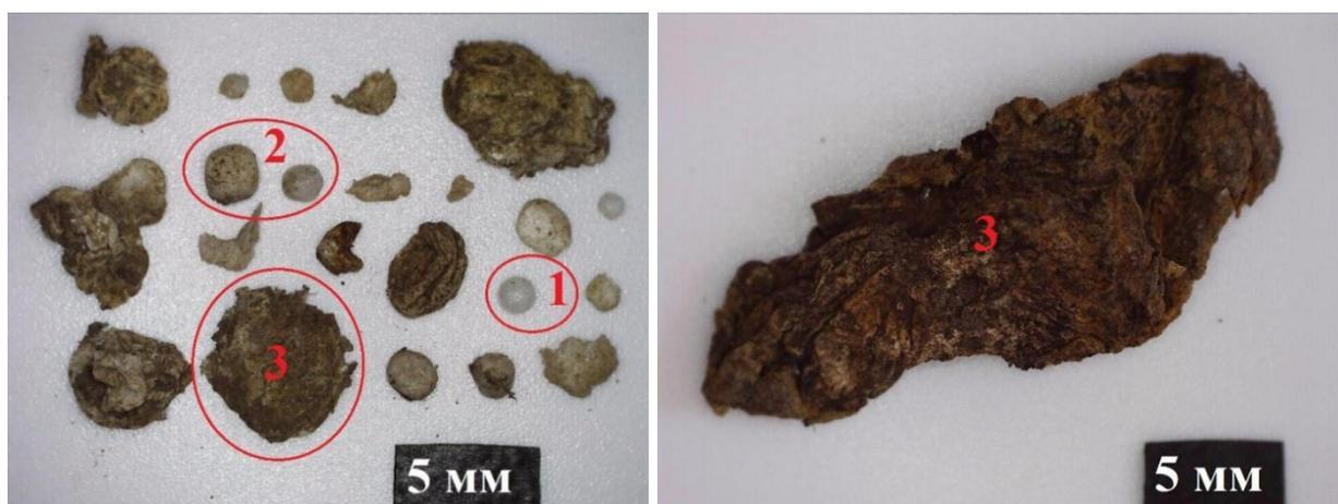
**Рисунок 3.** Примеры степени деградации поверхности частиц плёнки (а) и шариков пенопласта (б) в урбо-аллювиальной серогумусовой почве поймы реки Данилиха. Степень деградации поверхности частиц пластмасс, оценённая по Вебер с соавторами (Weber et al., 2022), на фотографиях обозначена цифрами: 1 – свежая, 2 – с начальными изменениями и 3 – выветрившаяся.
